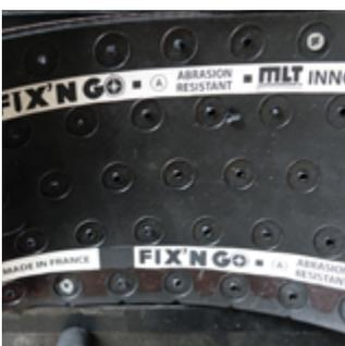
5| Montieren Sie einige Schrauben in Überlänge (beigefügt im Set).
