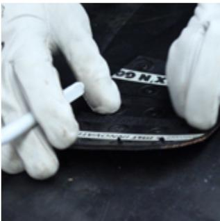
1| Schneiden Sie **FIX'N GO®** so zu, dass Sie mindestens 2 Reihen für die Schrauben haben. Beziehen Sie aus der Tabelle nebenstehend.
