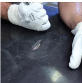
3| Ziehen Sie an der Linie entlang. Nicht die Karkasse des Förderbandes beschädigen.
