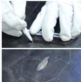
2| **FIX'N GO®** auf den Riss setzen (Oberseite des Bandes). Zeichnen Sie eine Markierung um den Flickern. Nicht die **FIX'N GO®** Schrauben auf den Riss schrauben.
