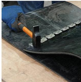
**2|** Verwenden Sie einen Hammer, um jede Verbindung vorher zu schließen. Wähle zwischen einer:
