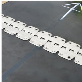
**4|** Nehmen Sie das andere Ende der Band. Fügen Sie es mit der bereits verschraubten Seite zusammen. Markieren Sie die Position des Verbinders. Fortsetzen von Schritt 2.
