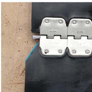
**5|** Schneide die Ecken des Bandes ab. Stecken Sie den Verbindungsstift in den Verbinder.
