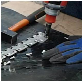
**3|** Beginnen Sie mit dem Schrauben der beiden Außenseiten, dann den mittleren Teil und anschließend den Rest.
