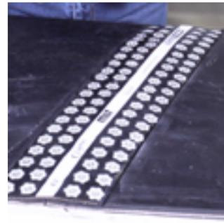
**21|** Setzen Sie die übrigen Schrauben ein, allerdings immer versetzt (einmal links und einmal rechts schrauben)
