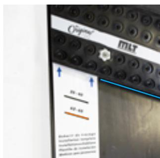
**8|** Markieren Sie das Band, an dem das Ende des Verbinders sitzt mit einer Linie. Markieren Sie auch die entsprechende Linie im Ausschnitt auf der Vorlage. In diesem Beispiel 63.
