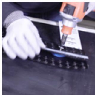
**5|** Montiert den oberen und den unteren Teil der Verbindung, indem die Schrauben bei den Distanzhaltern befestigen.
