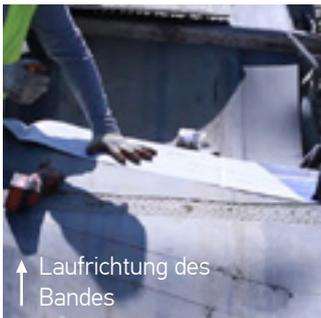
9| Drehen Sie die Installationsschablone so, dass sie rückwärts zur Laufrichtung des Bandes zeigt.
